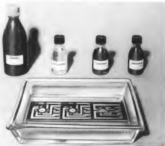
Ein Satz Chemikalien von der Firma Radio-Fern, Essen, zum Anfertigen von geätzten Schaltungen. Im Vordergrund eine Schaltplatte in der Ätzenschale
